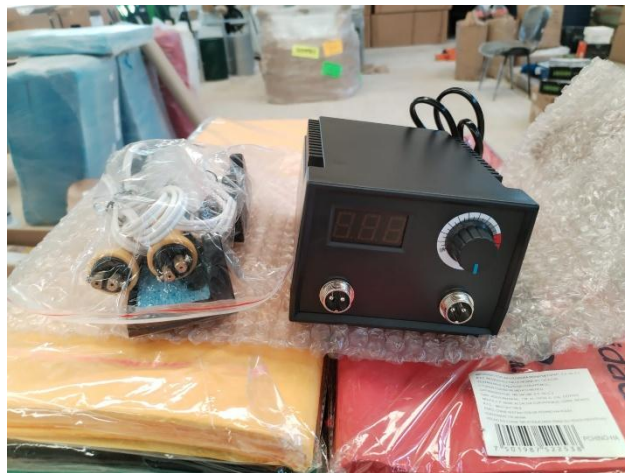
BMS 1.2.1.1.29 Cautin Pirograbador Puntas Temperatura Ajustable Madera. 100 w.
