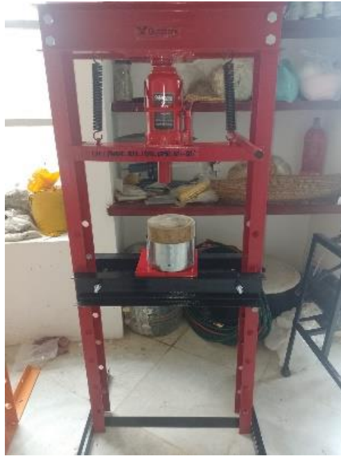
Fig 9. Uso de la prensa hidráulica para la extracción en frío de la manteca de cacao y aceites vegetales.
