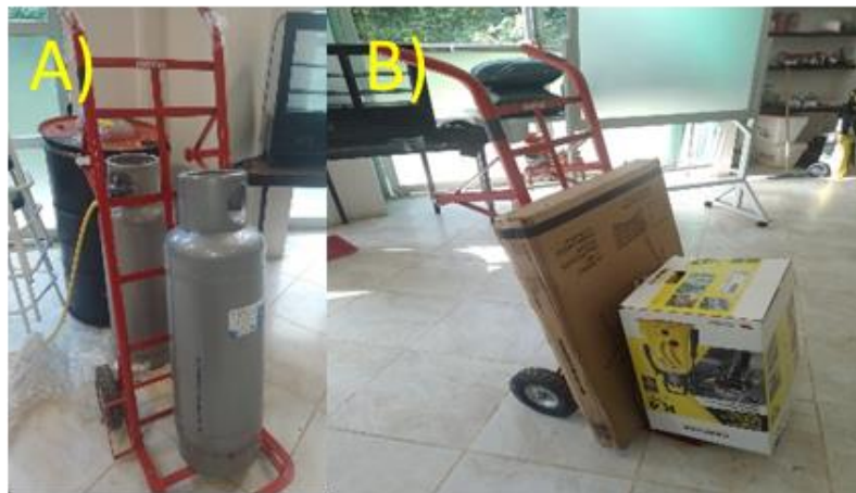
Fig 8. A) Uso en manejo del tanque de gas, B) Uso para carga pesada.
