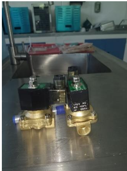
Fig.20.Electroválvulas para automatización.
