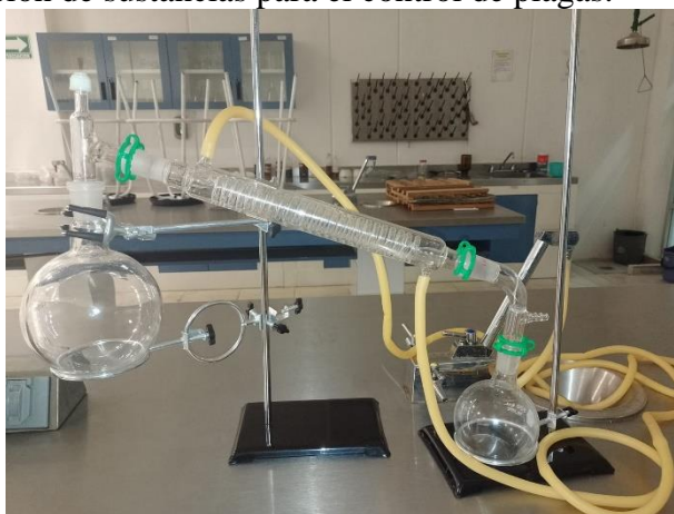
Fig.21. Kit para la destilación de productos y sustancias orgánicas.
