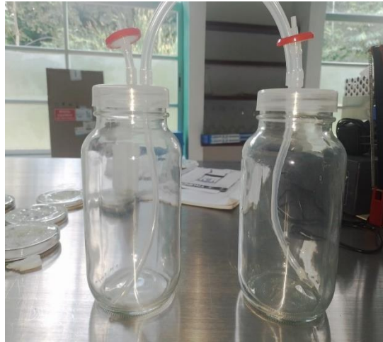
Fig. 17. Uso de los frascos gemelos como biorreactores.
