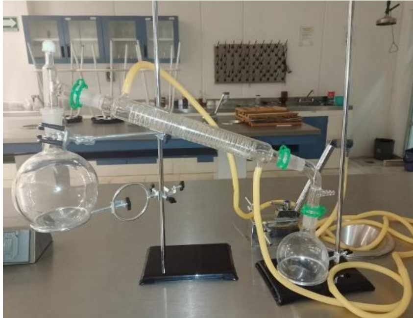
Fig 5. Utilización del soporte universal en el equipo de destilación
