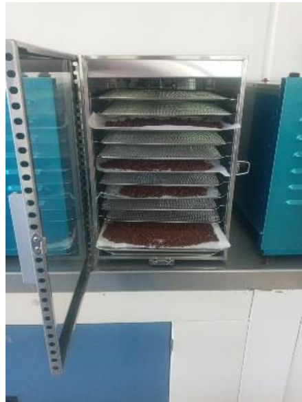
Fig 10. Deshidratadora funcionando para eliminar humedad en cacao
